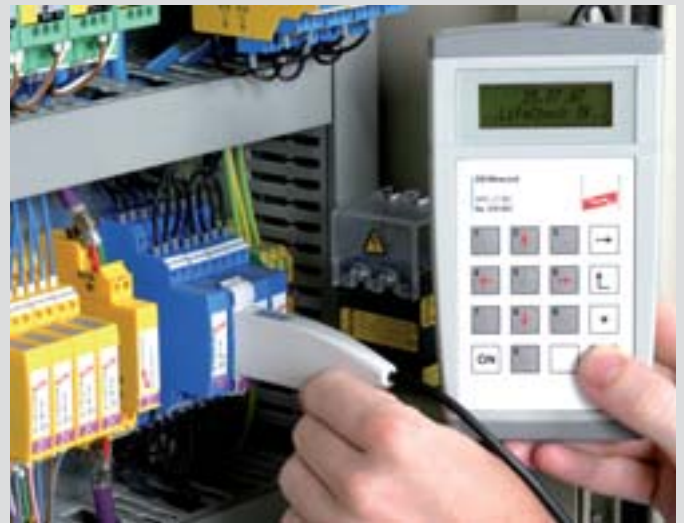
Test d'un module parafoudre avec la technologie RFID (LifeCheck) pour la protection de circuits de mesure à sécurité intrinsèque
