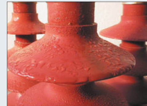
Figure 2 : Régénération des caractéristiques hydrophobes du parafoudre quelques heures seulement après le test agressif de 5000 heures.
