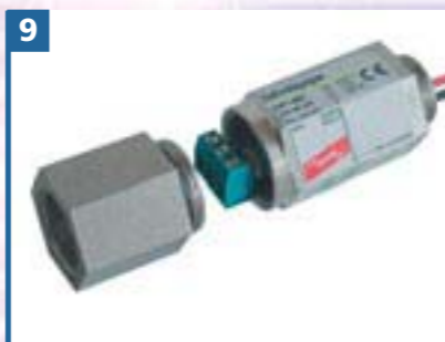
9 DEHNpipe Ex (i) DPI MD EX 24 M 2 Art.-Nr. 929 960 Eigensicherer Überspannungs-Ableiter aus Edelstahl für den Außenbereich (IP 67) zum Einschrauben in 2-Leiter-Feldgeräte Intrinsically safe surge arrester made of stainless steel for outdoor areas (IP 67) for screwing into 2-wire field devices
