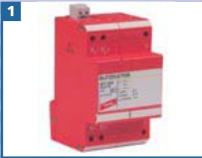
1 BLITZDUCTOR VT KKS BVT KKS ALD 75 Art.-Nr. 918 420 Blitzstrom- und Überspannungs-Ableiter zum Schutz aktiver Korrosionsschutz-Anlagen (Anodenstromkreis) mit integriertem Fernmeldekontakt. Einbau in Stahlblechgehäuse empfohlen
