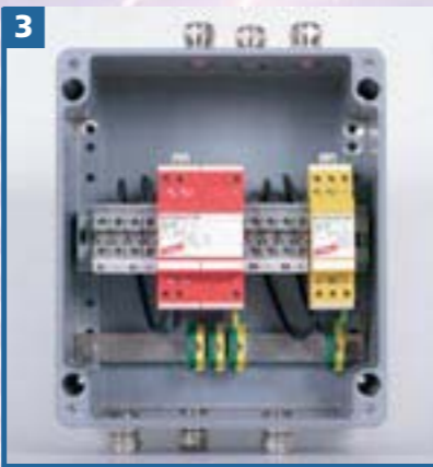
3 ITAK KKS Art.-Nr. 989 406/S; Serien-Nr. 4305 Anschaltkasten aus Aluminium, IP 65, zum Schutz von KKS-Anlagen, komplett bestückt mit Blitzstrom- und Überspannungs-Ableiter vom Typ BVT KKS ALD 75 + BVT KKS APD 36 Aluminium connection box, IP 65, for protection of CP installations, completely furnished with lightning current and surge arrester type BVT KKS ALD 75 + BVT KKS APD 36
