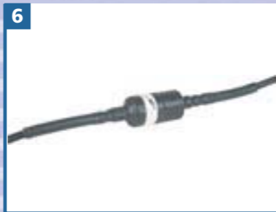
6 EXFS C1 KU Art.-Nr. 923 071 Explosionsgeschützte ATEX-Funkenstrecke zum Einsatz in Ex-Bereichen (Aussenbereich und unterirdisch; Zone 1 + 2) zum Schutz vor Überspannungen und Blitzströmen Explosion-protected ATEX spark gap for use in Ex zones (outdoor and underground areas; zone 1 + 2) for protection against surges and lightning currents
