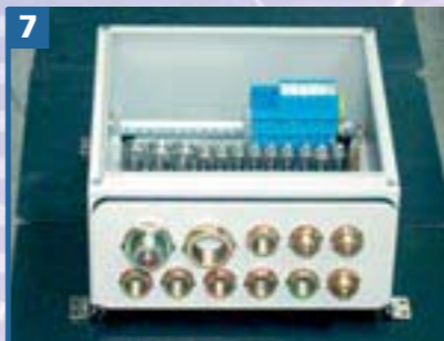
7 ITAK Ex (i) Art.-Nr. 989 406/S; Serien-Nr. 4321 Anschaltkasten aus Aluminium, IP 65, zum Schutz von eigensicheren Messkreisen, komplett bestückt mit eigensicheren Überspannungsschutzgeräten vom Typ BCT MOD MD EX 30 + BCT BAS Aluminium connection box, IP 65, for protection of intrinsically safe circuits, completely furnished with intrinsically safe surge protective devices type BCT MOD MD EX 30 + BCT BAS
